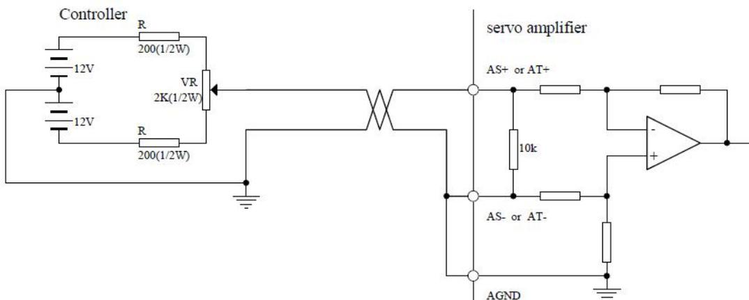
图 4-6-4d Type4 模拟单端电位器输入接口
