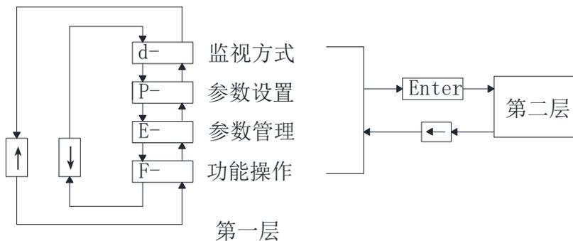
图 5- 1: 方式选择操作框图
