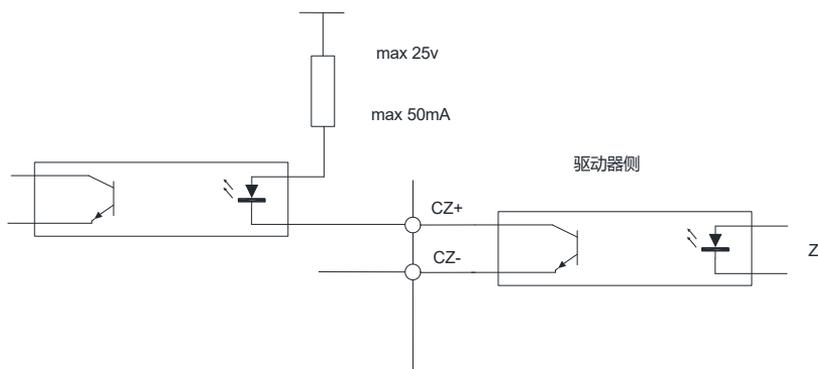
图 4- 6-6: Type6 Z 信号输出接口
