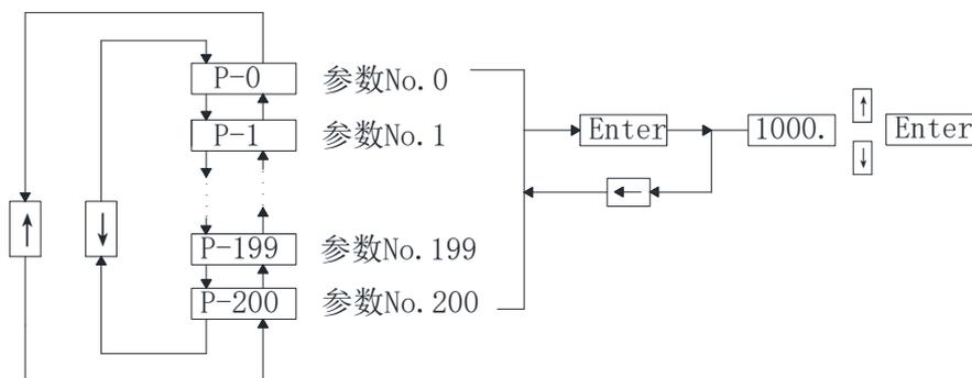
图 5- 1: 参数设置操作框图
