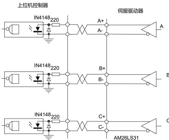
图 4- 6-5b: Type5 编码器输出信号
