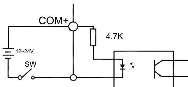
图 4- 6-1: Type1 开关量输入接口
