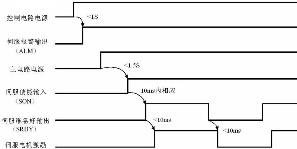
图 15- 2: 电源接通时序图
