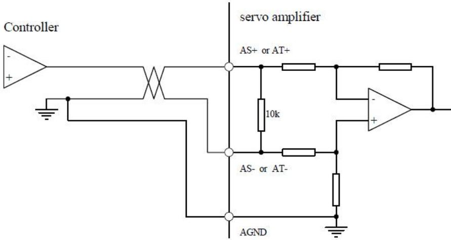
图 4-6-4a Type4 模拟差分输入接口
