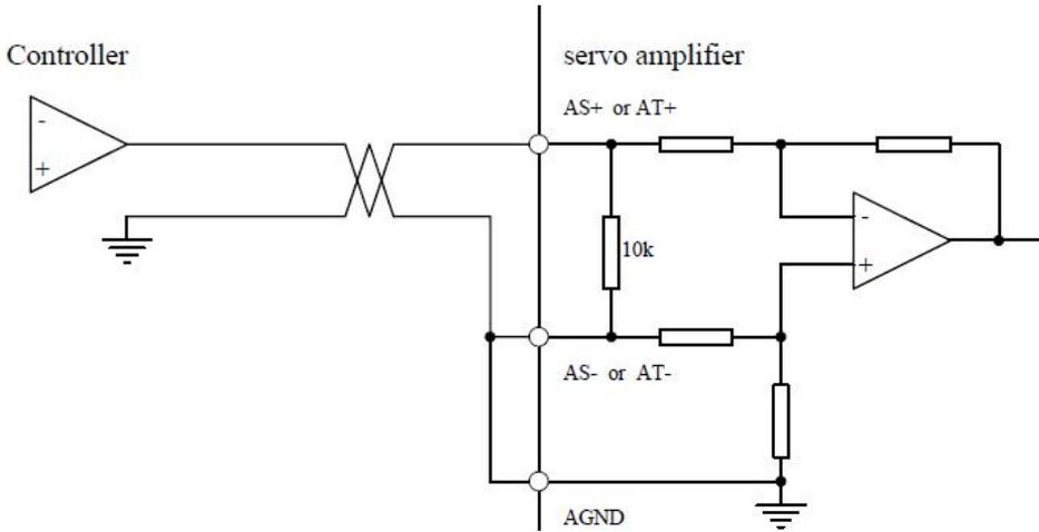
图 4-6-4b Type4 模拟单端输入接口
