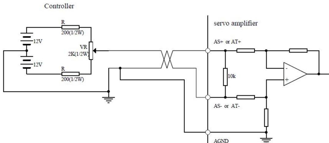
图 4-6-4c Type4 模拟差分电位器输入接口
