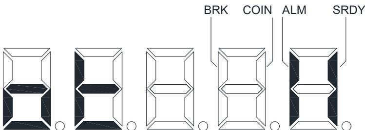
图 5- 4：输出端子显示（笔划点亮表示 0N，熄灭表示 0FF）
