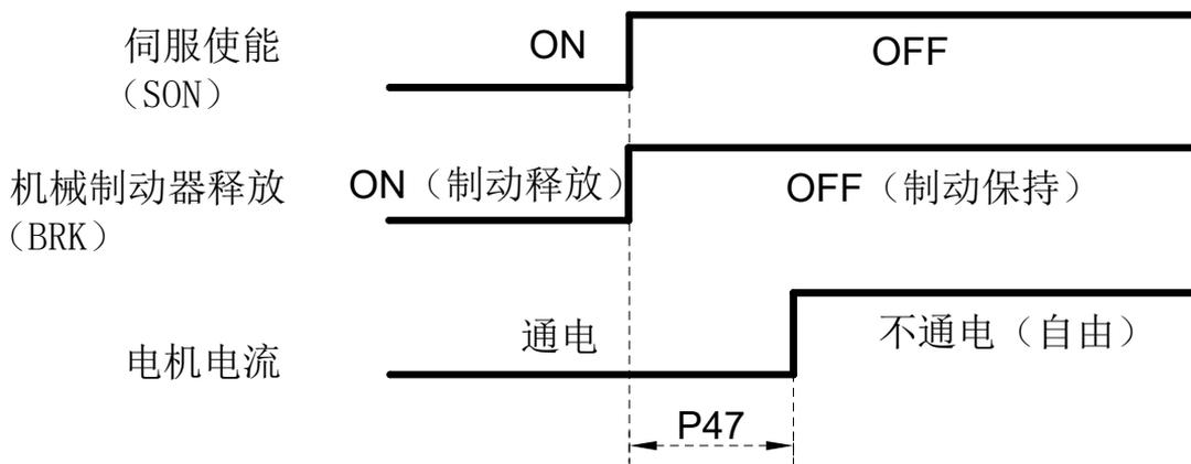
图 15- 4: 电机停止时机械制动器动作时序
