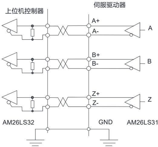
图 4- 6-5a: Type5 编码器输出信号
