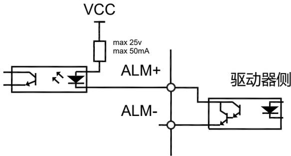
图 4- 6-2a: Type2 开关量输出接口（光耦）
