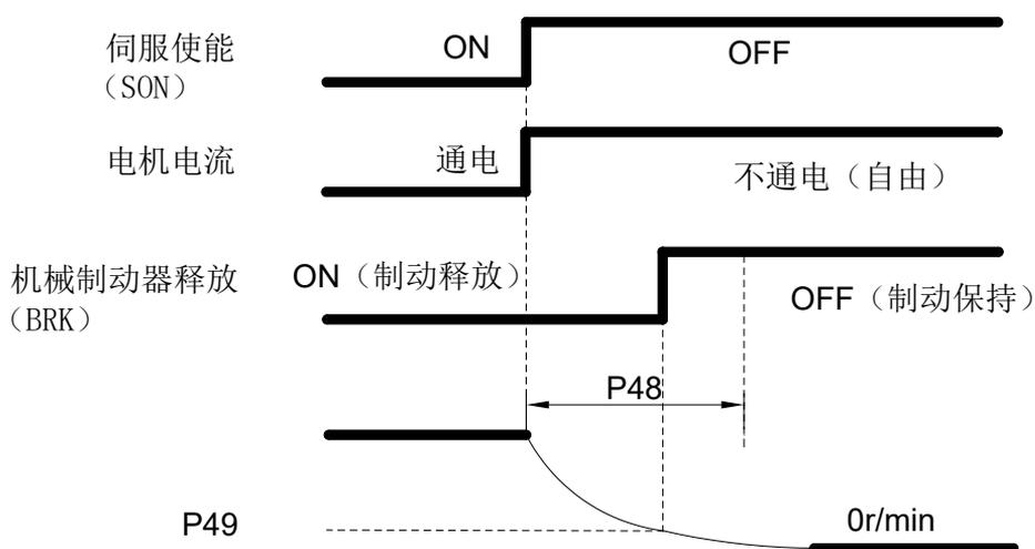
图 15- 5: 电机运转时机械制动器动作时序
